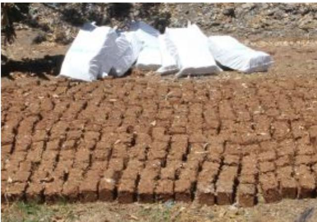
A partir du **mélange de déchets de bois et de déchets de papier ou de carton** hautement compressé, on obtient des briques. Elles sont ensuite séchées au soleil. Ces briques combustibles peuvent également être une alternative au charbon classique pour les foyers. Son pouvoir calorifique et son coût de revient, issu à nouveau de la valorisation de déchets, lui fournissent de gros avantages. Il faudra toutefois le faire connaître car il s'agit là d'un produit novateur.
